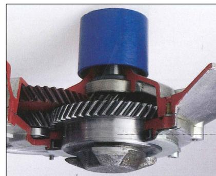
Planetengetriebe mit Werkzeugaufnahme
