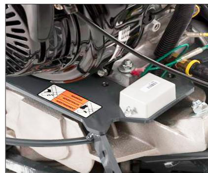
Un arrêt de gyroscope pour plus de sécurité
