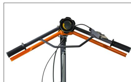
Vis pour l'inclinaison des pâles / Poignée actionnent la machine
