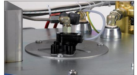
Contrôle optique de combustion
