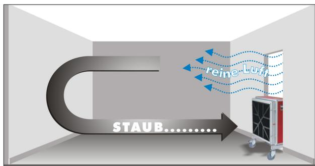
Luftreiniger in der Türöffnung aufstellen und einschalten. Im Raum entsteht ein Vakuum und die verunreinigte Luft gelangt gereinigt durch einen HEPA-Filter des Luftreinigers, mit einer Effizienz von 99.97% bei 0,3 µm, in den Nebenraum. Dort wird ein Überdruck mit sauberer Luft erzeugt, welche dann wieder in den Raum mit der Staubentwicklung weichen kann.
